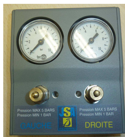
Bloc manomètres équipés de valves de dégonflage permettant d'adapter la pression à droite et à gauche pour répartir la charge.
