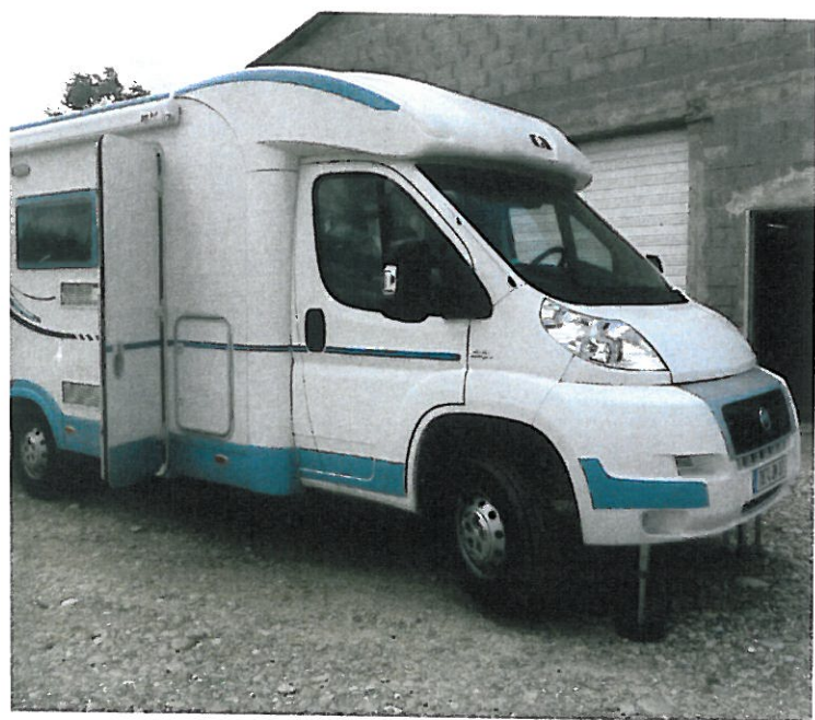
Chez JSA, on a développé un système automatique de mise à niveau hydraulique car il reste plus fiable qu'un électrique...
