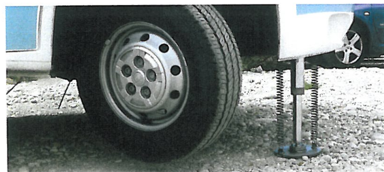
En cas de problèmes, on peut toujours actionner manuellement les vannes de retour hydraulique à clapets de sécurité et les ressorts de rappel rétracteront mécaniquement les vérins pour continuer à rouler !
