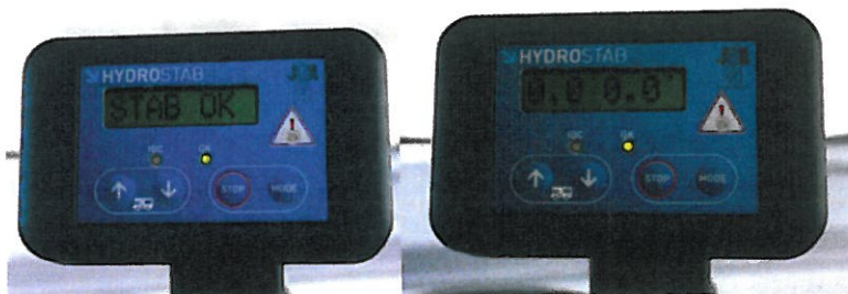
Le pupitre de commande, ici en fin d'opération, affiche diverses infos dont les degrés des 2 pentes et permet aussi de réaliser un autotest de maintenance.
