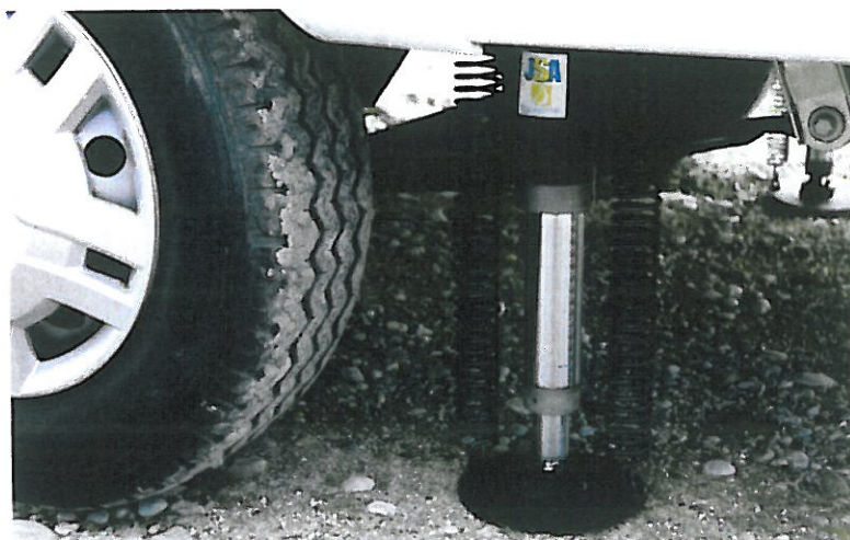
Ici à l'arrière d'un châssis X250, notez le plateau monté sur rotule qui épouse au mieux les contours du sol et ainsi s'enfonce au minimum.
