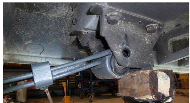
Fixation AVANT : couple de serrage 255N.m.
