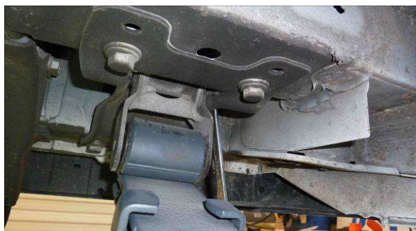
Fixation ARRIERE : couple de serrage 120N.m.
